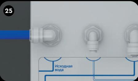
Свободный конец синей трубы, ранее подключенной к шаровому вентилю-адаптеру, подключите к фитингу насосного блока (Исходная вода) согласно рисунку.
