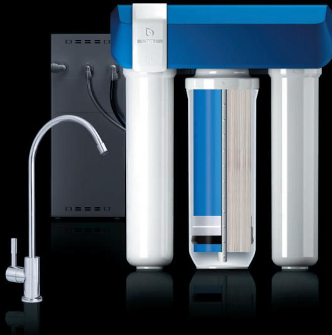
Основной элемент фильтра — обратноосмотическая мембрана. Она очищает воду от примесей на молекулярном уровне. Стабильная и эффективная очистка в бытовых условиях от таких трудноудаляемых примесей, как тяжелые металлы, фториды, соли жесткости, нитраты и нитриты, а также от бактерий и вирусов, возможна только при использовании обратноосмотической мембранны.
